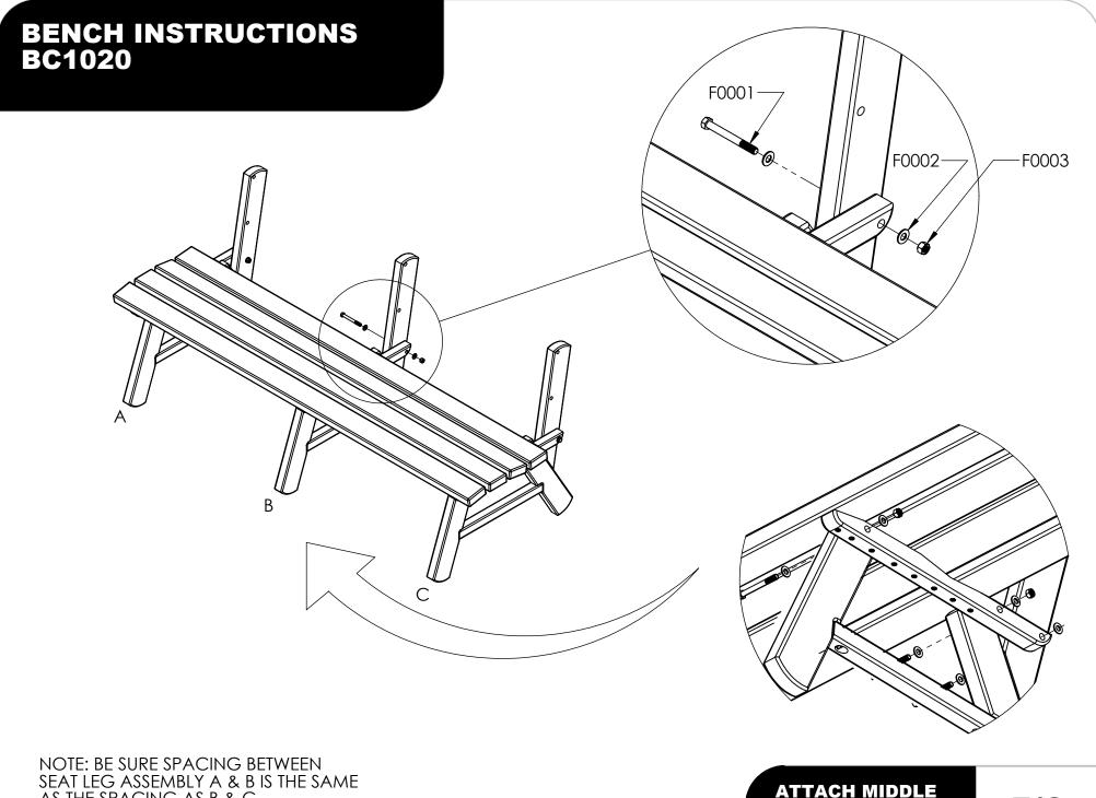
SEAT LEG ASSEMBLY A & B IS THE SAME AS THE SPACING AS B & C.
